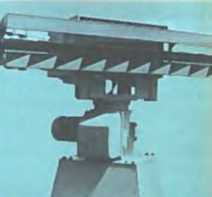
Pilot er et radarsystem, der er næsten umuligt at opdage ved signalopklaring.
