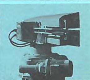
Pilot er et radarsystem, der er næsten umuligt at opdage ved signalopmåling.
