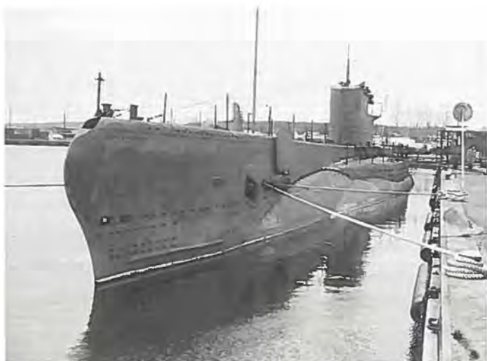
Fig.2. Undervandsbåden LEMBIT i Tallinn havn 1993. Bevæbningen var 20 miner, 8 torpedoer (4 torpedorør i boven), 1 stk. 40 mm Bofors luftværnskanon. Deplacement i overfladen 665,5 t. Hastighed i overfladen 13,5 knob, neddykket 8,5 knob. Maksimal dykkedybde 90 meter.
