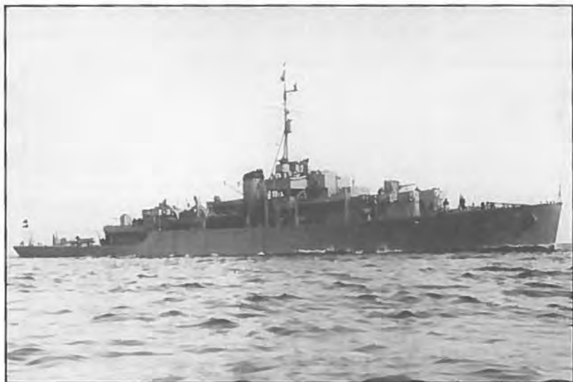
Fregatten HOLGER DANSKE af engelske RIVER-klasse som dansk Kadetskib. Det ses, at dydbombearmeringen på agterdæk er fjernet og erstattet med 45 cm og 20 mm rekyllkanoner. Øvrige armering uændret.
