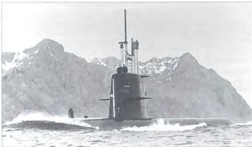
Svensk GOTLAND-klasse med Stirling AIP-maskineri.
