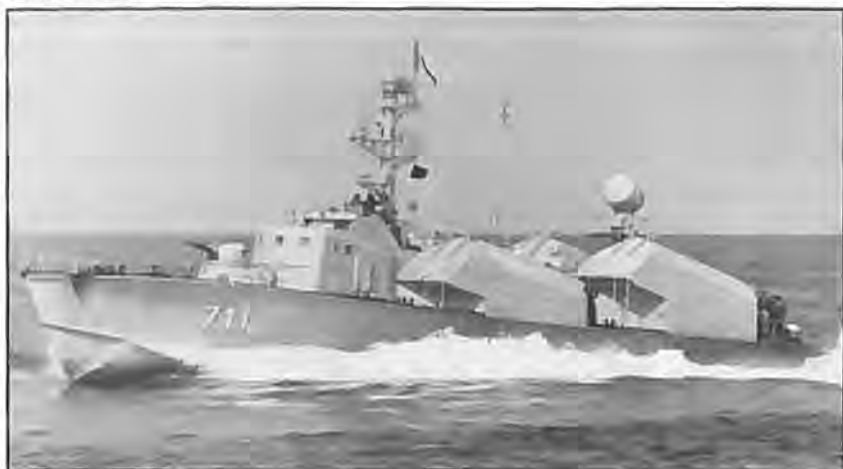
Østtysk missilbåd af OSA-klassen i Østersøen 1974. Denne klasse var WPs standard missilbåd udrustet med 4 antiskibsmissiler af STYX typen, der havde en rækkevidde på 25 sømil.
