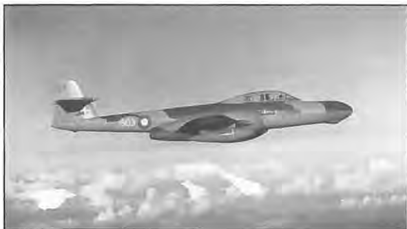
En natjager fra det danske flyvevåben af typen METEOR Mk. 11 med radarudstyr i næsen. NATO lagde fra starten vægt på opbygningen af det fælles luftforsvar.
