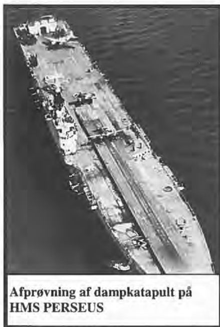
Afprøvning af dampkatapult på HMS PERSEUS
