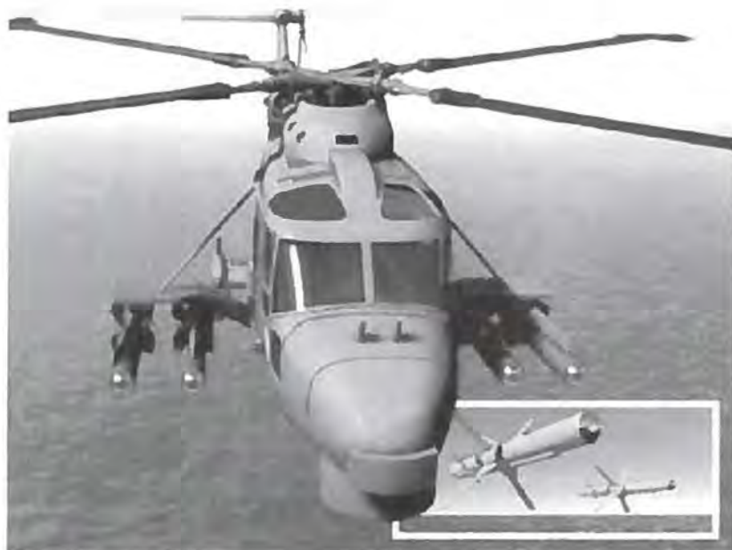
Super Lynx med 4 Polyphem luft-til-overflade missiler
