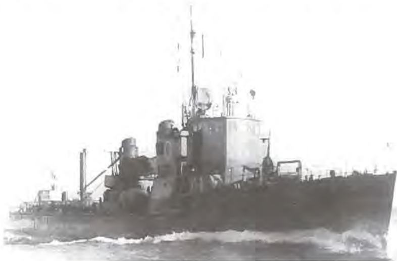
Fig. 14: Hvalen i tysk tjeneste under navnet TFA 5. TFA stod for Torpedofangboot Ausland. Bemærk kranen på agterdækket, der blev brugt til indtagning af torpedoer.
