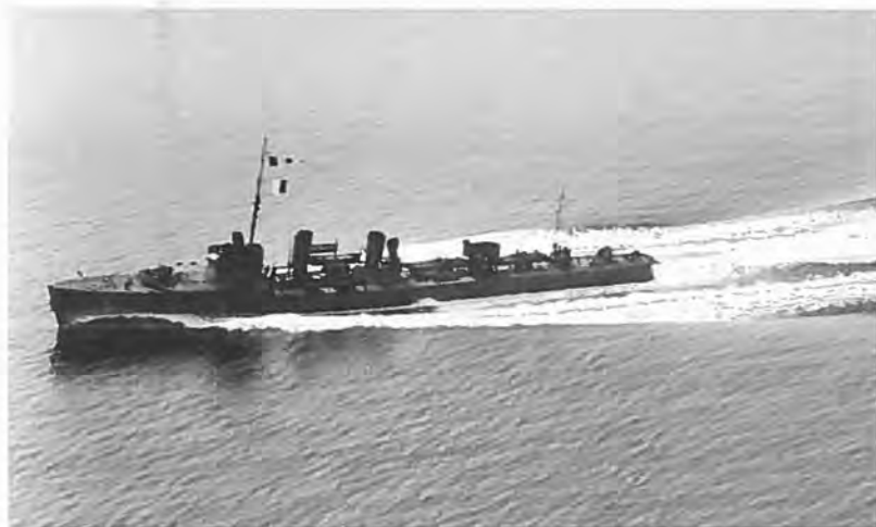
Fig. 13: Bådene fik en topfart på ca. 29 knob og var armeret med otte torpedoer (Dragen-kl.) og (Glenten-kl.), 45cm torpedoudskydnings-apparater, samt to 75mm(Dragen-kl.) og to 87mm(Glenten-kl.) kanoner. Besætningen var på 51 mand. 65
