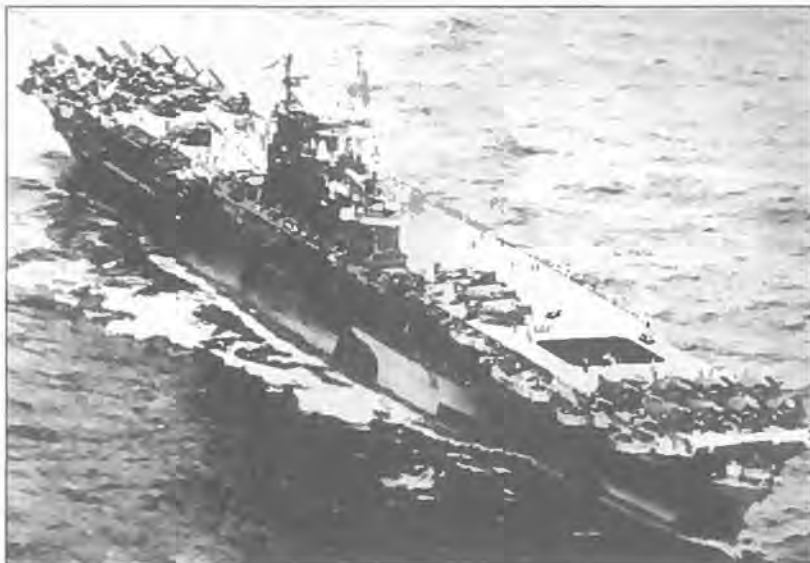
Det amerikanske hangarskib "Enterprise" med fly parkeret på flydækket. "Enterprise" deltog i slaget ved Midway i 1942. Bemærk i forskibet elevatoren til hangardækket under flydækket.
