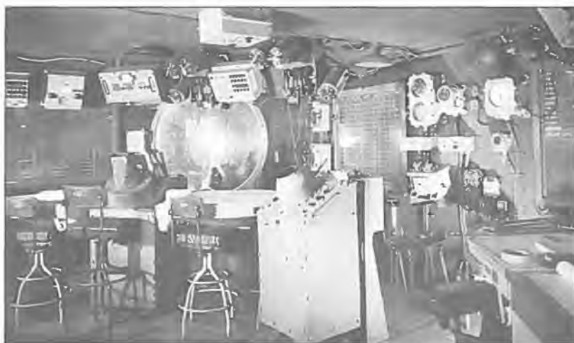
US Navy "Combat Information Center", 1944". Billedet viser indretning af et "Aircraft Direction Center" i et større amerikansk hangarskib. Udover det centralt placerede luftplot med omkringstående PPI skoper bemærkes de mange "stateboards" og "totes" i baggrunden og forrest til højre et DRT overfladeplot.
