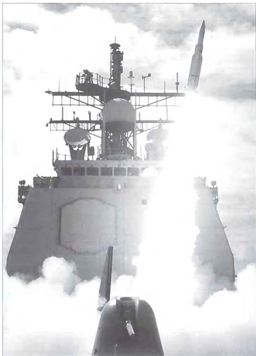
Et SM-2 missil affyres fra Vincennes' forreste launcher ca. 1987. Missilet havde en topfart på mach 2 og en rækkevidde på 18 sømil – men kunne ikke engagere mål tættere på end 10 sømil, da missilet da ikke kunne nå den nødvendige fart til at manøvrere. 70
