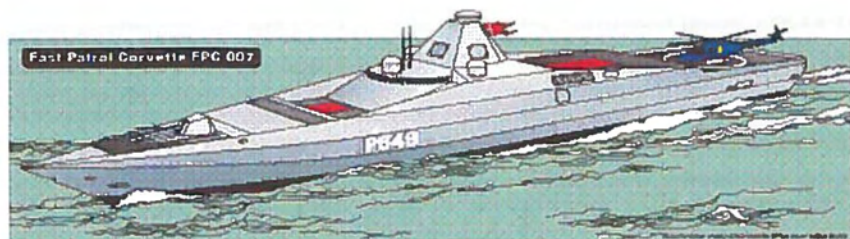
Figur 23. Fast Patrol Corvette, ca. 1800 tons med alsidig moduludrustning inkl. organisk minerydningskapacitet
