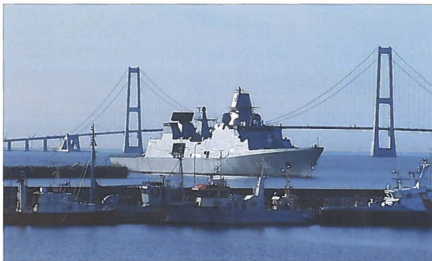
To flotte eksempler på dansk ingeniørkunnen. F 361 ankommer FLSKOR fra OSS efter installation af APAR antenne(forreste mast). Bemærk de kugleformede SATCOM antenner.(Foto søværnet)
