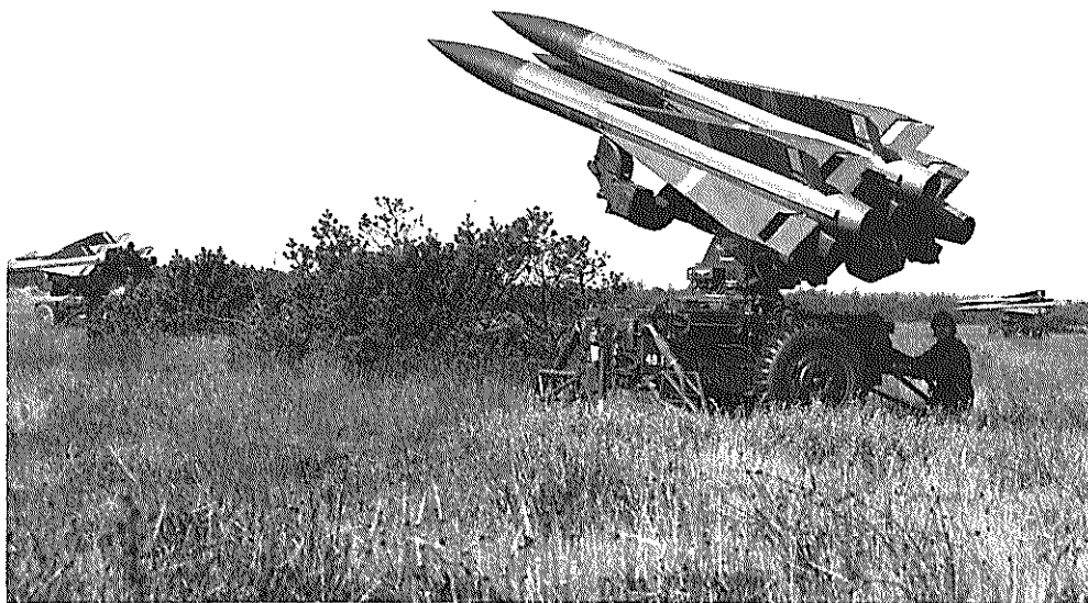
IHAWK raketsektionen består af 3 launchere med 9 raketter, som har en rækkevidde på ca. 40 km. Foto. Flyvevåbnet
