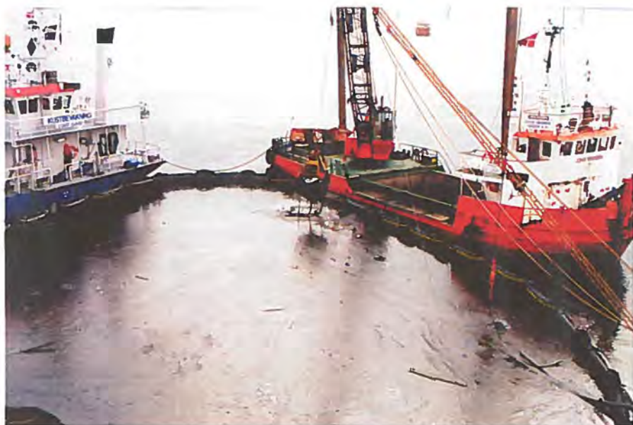
Inddæmning og olieopsamling med sandpumper efter olieudslippet 29. marts 2001 i Kadetrenden. (Billede: Søværnet i Korsør).
