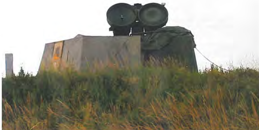
High Powered Illuminator Radar som bruges til at følge et luftmål. (Billede: Christian Pejstrup).
