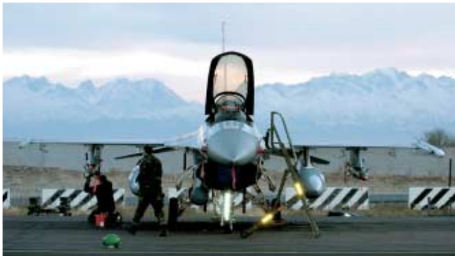
F-16 under klargøring til mission fra Manas i f.m. operation Enduring Freedom. Her udføres kontrol af laserstyret bombe GBU 12. Foto: Brian Jacobsen, Flyvevåbnets Fototjeneste.
