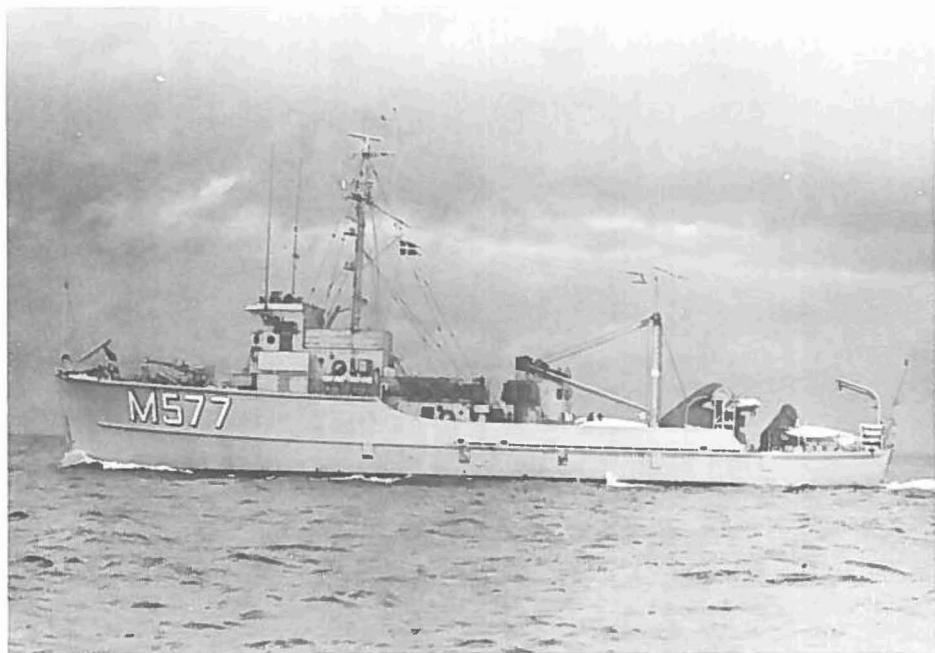
Figur 19: Minestryger af SUND-klassen, der anvendes ved bl.a. søopmåling, forureningsbekæmpelse og til minestrygning
