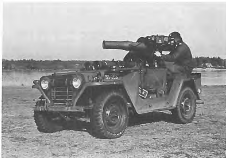
På jeepen er monteret et 147 mm raketstyr M/74, kaldet TOW (Tube-launched Optically-tracked Wire-guided missile)
