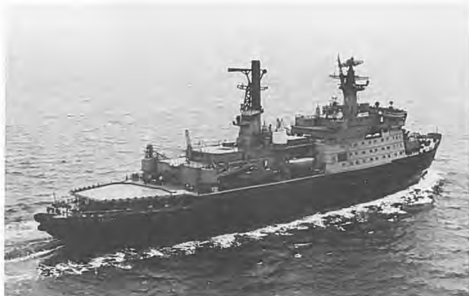
Figur 23: Russisk atomdrevne isbryder ARKTICA under passage af danske farvande på vej mod Polhavet. Displacement: 25.000 tons, maskinkraft: 75.000 HK. Foto: Søværnet
