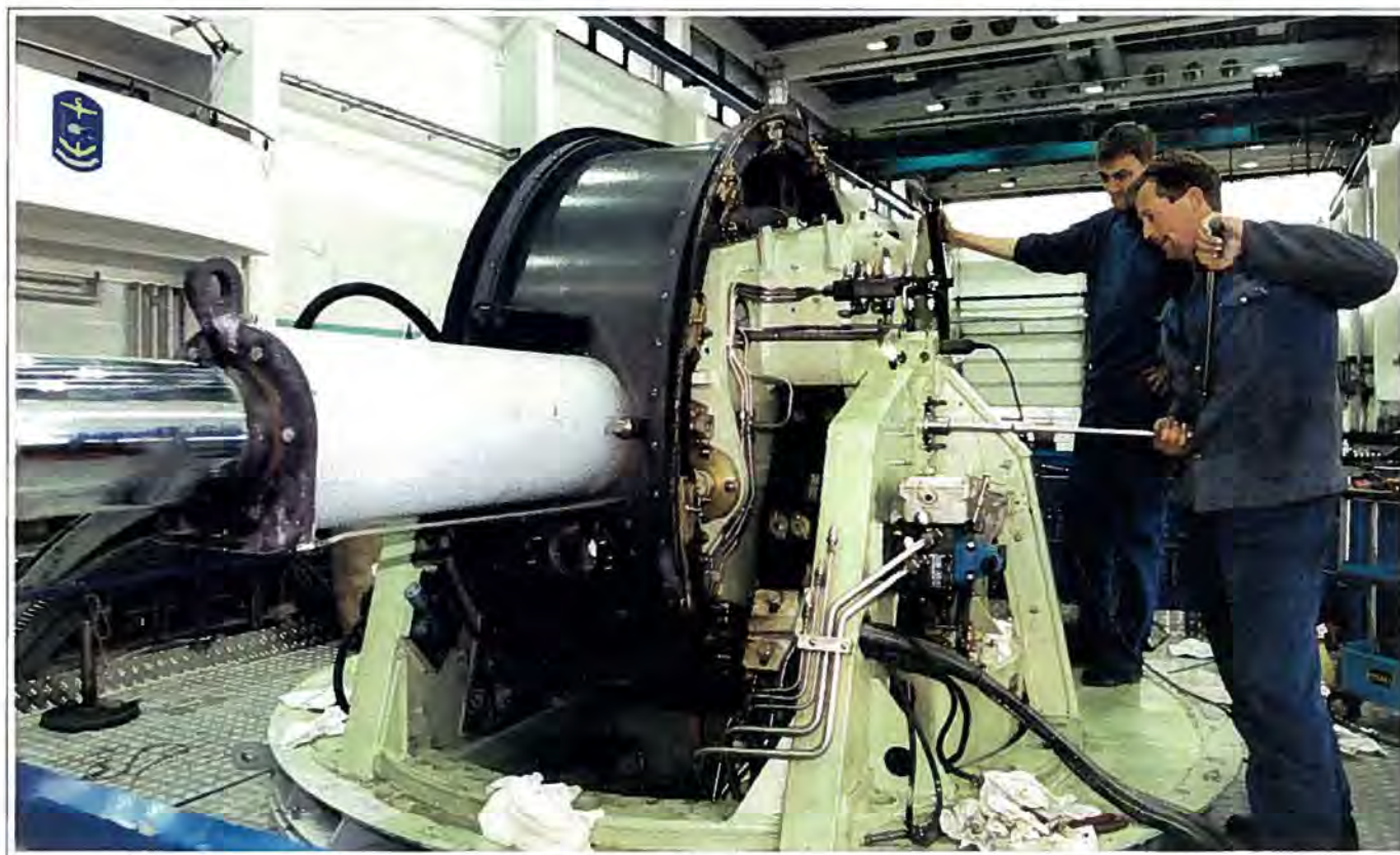
Maskinarbejderne Henrik Trudslev og Jan Wrensted i færd med at afmontere en aksel for rockkingarm.
