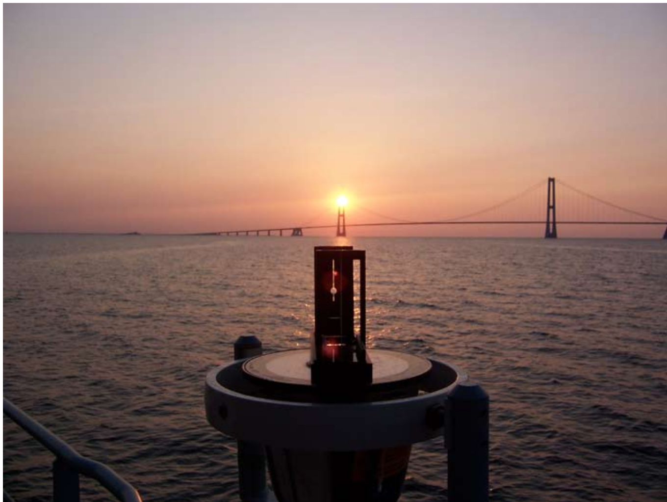
Pejdioptret er det primære værktøj for optisk navigation.
