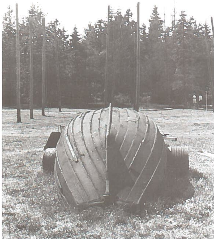
5. 19-fots hommebåt från Stenshuvud söder om Kivik. Till typen blekingseka, men med den för hommebåtar typiskt »flata» botten.
