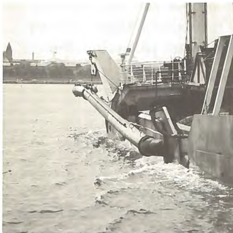
Sandsuger på vej ind fra sugning i Køge Bugt. Går sådant et sugerør igennem et historisk vrage, kan det blive til ubodelige skade for en senere videnskabelig undersøgelse. Foto: Birger Thomsen 1982.
