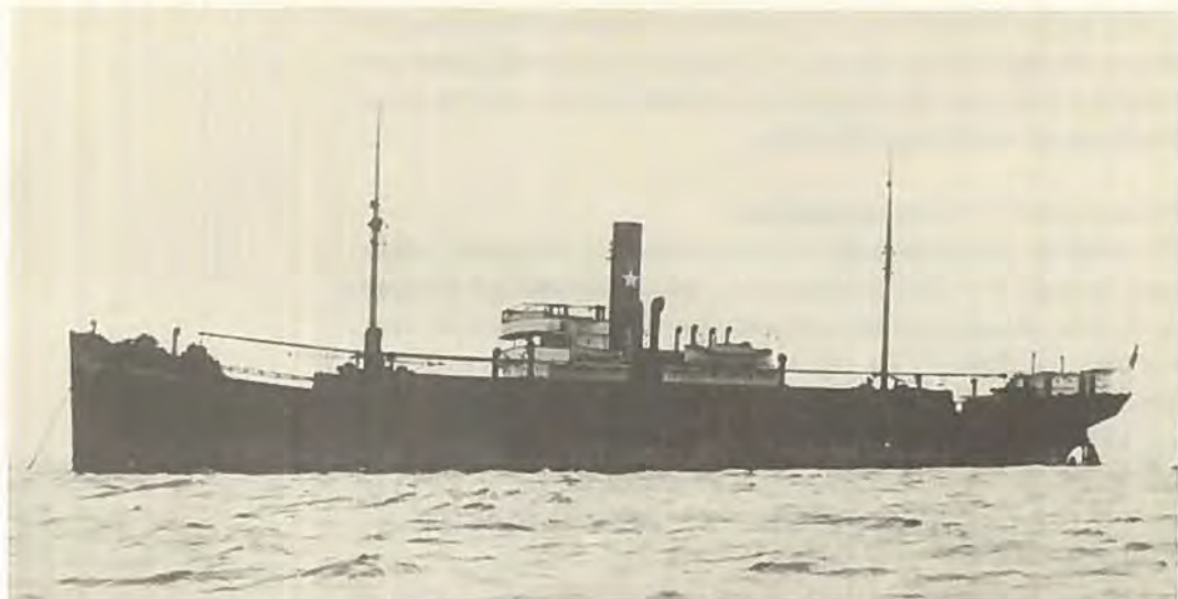
Danemark, byggenummer 1 fra Balticaværftet, leveret november 1920 til D/S Dana, 1926 overgået til D/S Halla og omdøbt til Øresund. Skibets turbineanlæg blev i 1927 udskiftet med en konventionel tregangs- dampmaskine. Samme år solgt til Sverige.
