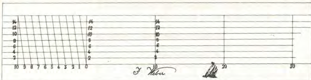
Opmåling af en målestok af mes- sing med inddeling i sekstende- dele. Har været anvendt af sejl- mager J. C. Svane i Ærøskøbing og har tilhørt en ukendt J. We- ber. Tegnet af Morten Gotzsche.
