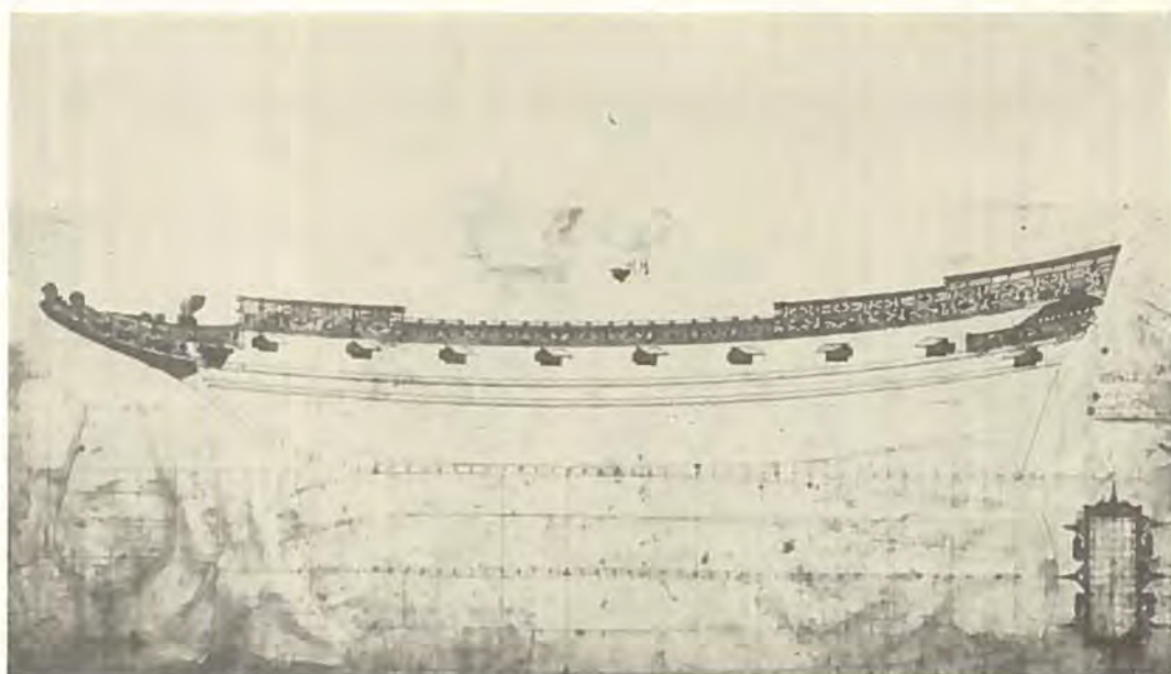
James Robbins sen. (?), lille engelsk skib. Sort tusch med illuminering på pergament. Målestokken på 12 fod er 77,5 mm lang. I skala 1:48 modsvare det en fod på 31 cm. Alle konstruktionslinier er forsynet med engelske betegnelser, f.eks. kaldes bredelinien i plan »upper lyne of the narrowing«. Længst til højre ses en standardberegning af drægtigheden: 68X21X8 fod divideret med 100 giver en »burden« på »114 tones«. 330X810 mm. RA SøE K&T Des. A 931.
