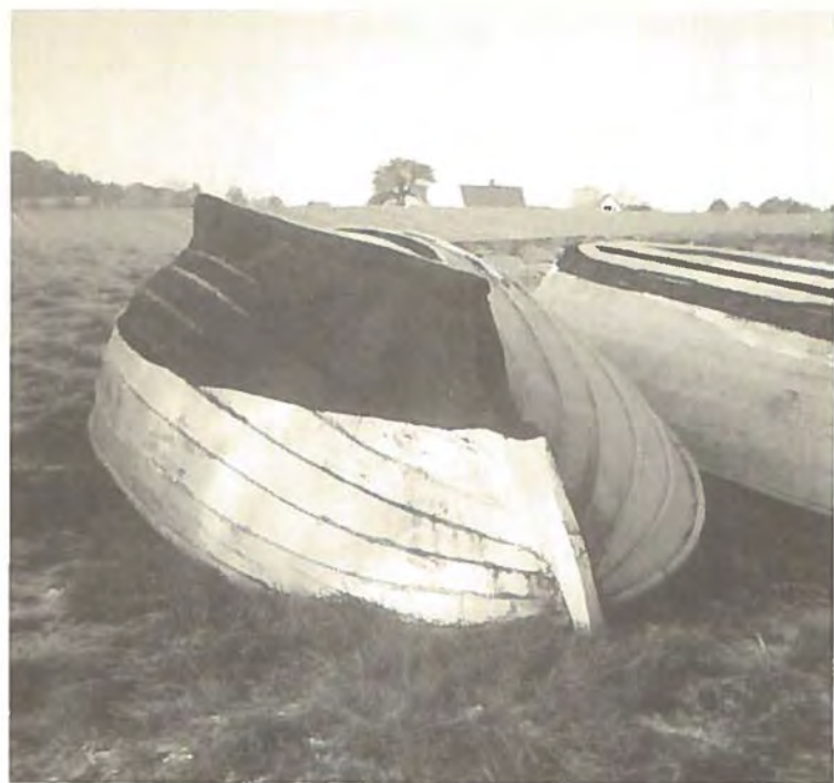
En af Frode Hansens joller, bygget af Valdemar Bådebygger. Den er beregnet til en lille maskine, der dog aldrig blev installeret. Bemærk slid-listerne på bordkanterne. Båden bales altid på land.
