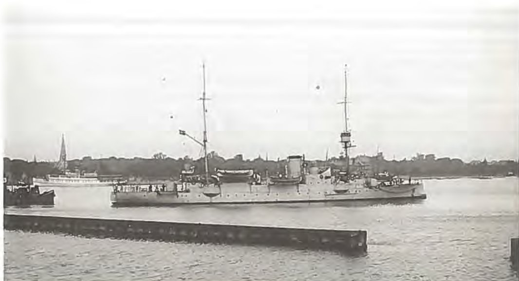
Krydseren Hejmdal forlader flådens leje. Det 71 m lange skib var bygget på Orlogsværftet i 1894 og havde et displacement på 1342 tons. Det udgik af flådens tal i 1930. (Orlogsmuseet).
