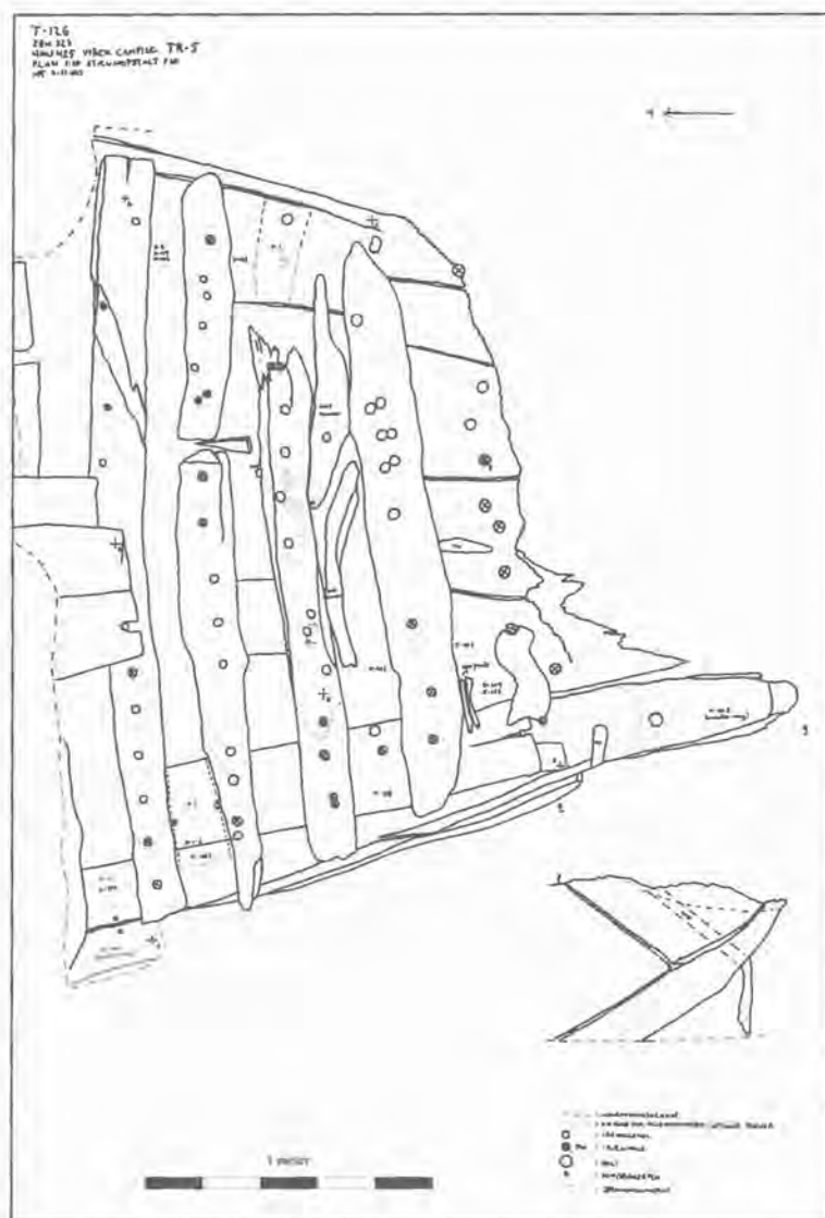
Fig. 5. Vraget NMU 425. Udgravningsplan af forstævn og forreste bordplanker i bagbords side samt stævnopstals. Tegning: forfatteren efter originalopmålinger af kursusedtagere.
