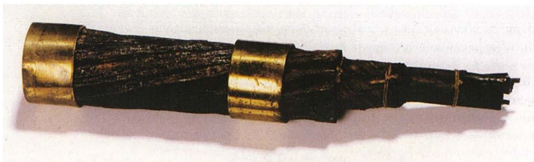
Et søkabel af ældre model, hvor man tydeligt kan se de mange lag og beviklinger, der gjorde en reparation til et noget omstændeligt arbejde, som man oven i købet kunne blive søsyg af. (Post- og Tele Museet.)
