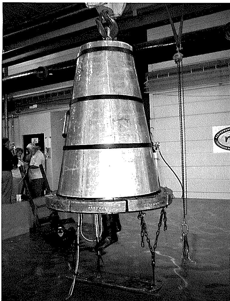
Fig. 10. Dykkerforsøg med norsk rekonstruktion af den af Triewald beskrevne klokke. Dykkeren sidder på en bæk inde i klokken. Triewald beskriver en opklappelig bæk, men viser den ikke på sine tegninger. (Foto fra Ancient Bell Diving Seminar, Bergen 2005).
