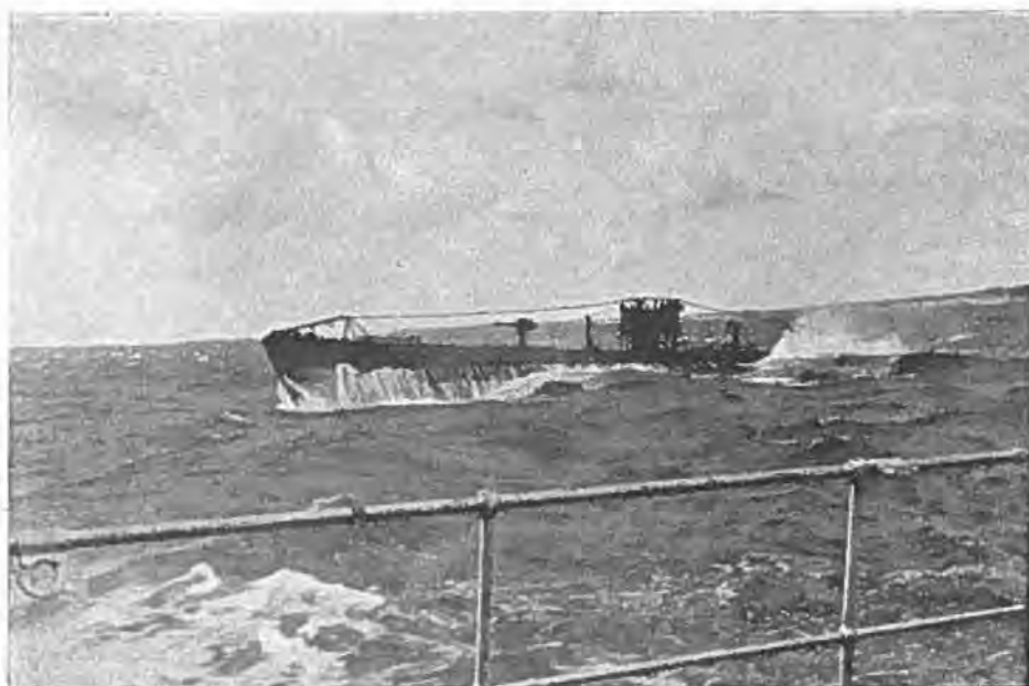
Fig. 90. Uddykket Ubaad med Periskoperne helt nede. Over Stævnen ses den Sav, hvormed Masker i Ubaadsnet kan overskæres. Fra Savens Agterende fører en Staaltraads-Trosse over Broen agter efter.
