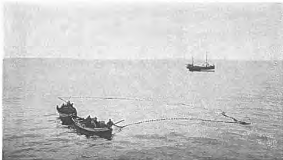
Fig. 244. Snurpenoten er roet omkring en Sildestime. Noten snurpes derefter sammen forneden, saa at Fiskene kan øses op med Kotsjere.
