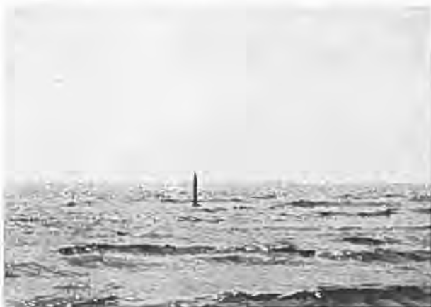
Fig. 89. Ubaads Periskop helt oppe. Til »Kig« under Angreb stikkes kun den øverste smalle Del af Periskopet op.
