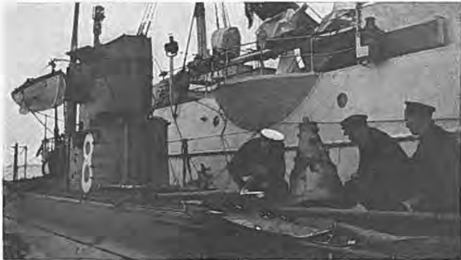
Fig. 91. Krigsmæssige Ubaads-Øvelser er ikke ufarlige. Her ses Ubaaden ÆGIR paa Siden af Værkstedsskibet GRØNSUND efter Kollision i neddykket Tilstand med en Torpedobaad i 1925. Ubaadens Fordæk oven over Trykskroget var plejet op, Kanonsokkelen revet op, og Kanonen laa paa tværs foran for Taarnet. (Fot. Orlogskaptajn Steensen).
