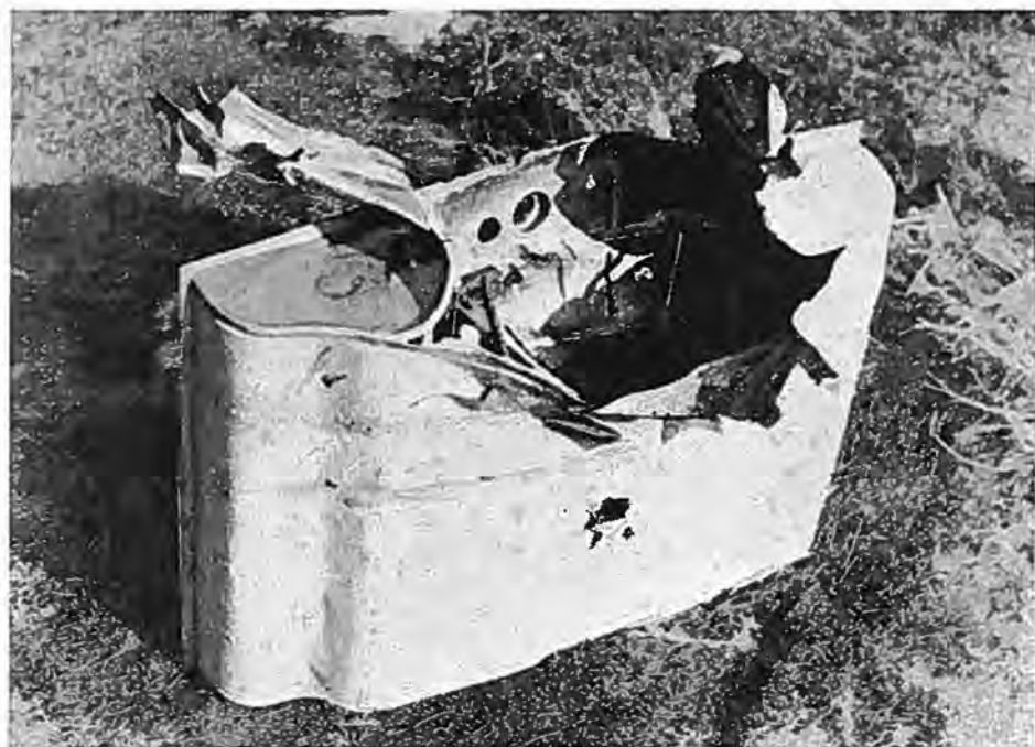
Fig. 135. Virkning af 20 mm. Projektil i en Flyvemaskines Benzin ank.
