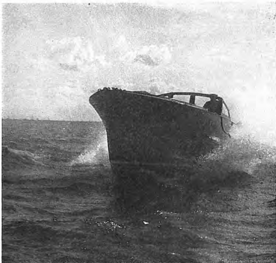
Fig. 253. Motorbaaden SEALs Stevn kaster Vandet ud til Siderne, saa at Føreren har fri Udsigt. (Fot. Ludvig Svendsen.)
