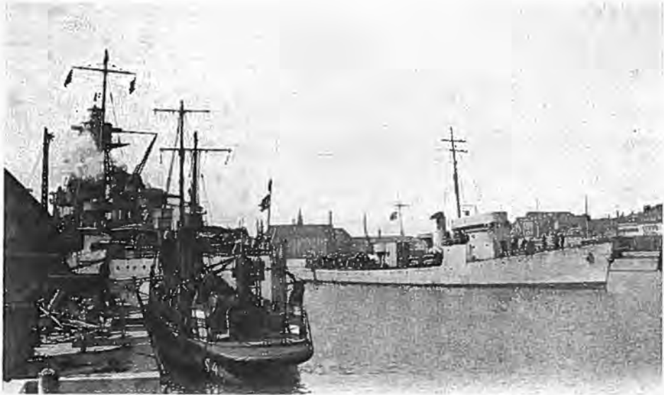
Fig. 96. Ministrygeren SØLØVEN og den til Ministryger ombyggede Torpedobaad SØHUNDEN set agter fra, saa at den paasatte Platform til Ministrygningsgrejer kan ses. (Fot. Orlogskaptajn Steensen).
