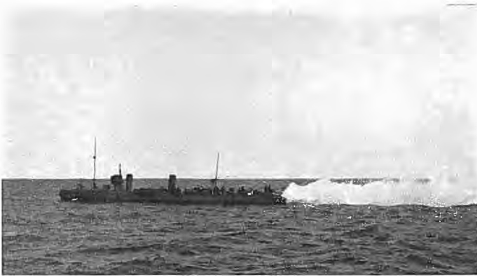
Fig. 94. Torpedobaaden HAVØRNEN udlægger kunstig Taage. 1926. (Fot. Orlogskaptajn Steensen).
