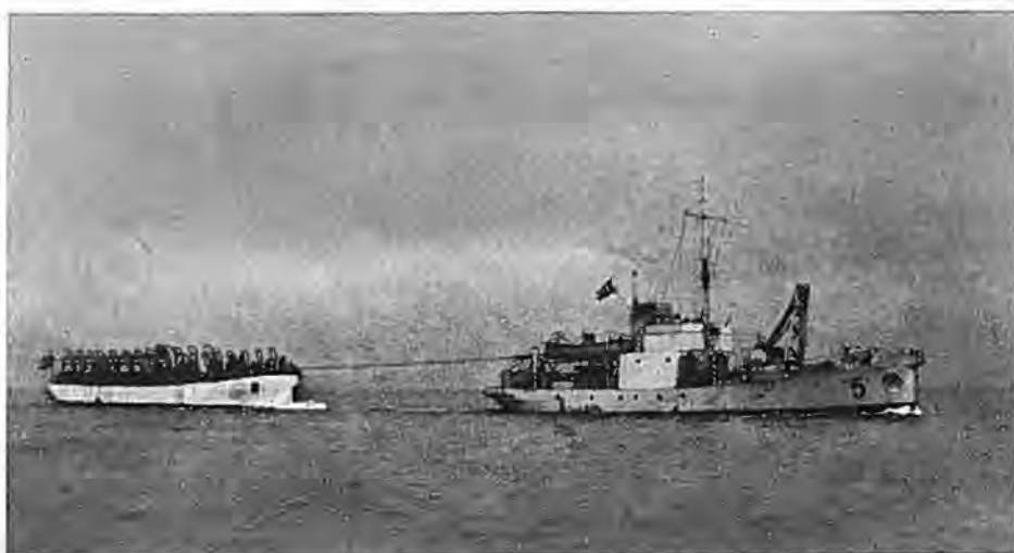
Fig. 102. Minefartøjet KVINTUS med en Minebaad paa Slæb. Minebaaden er forsynet med talrige Davider, hvori Minerne ophænges. 1924. (Fot. Orlogskaptajn Steensen).
