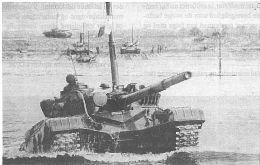
T-72 kampvogn. Her på vej op af vandet med påmonteret snorkel efter dybdevadning.
