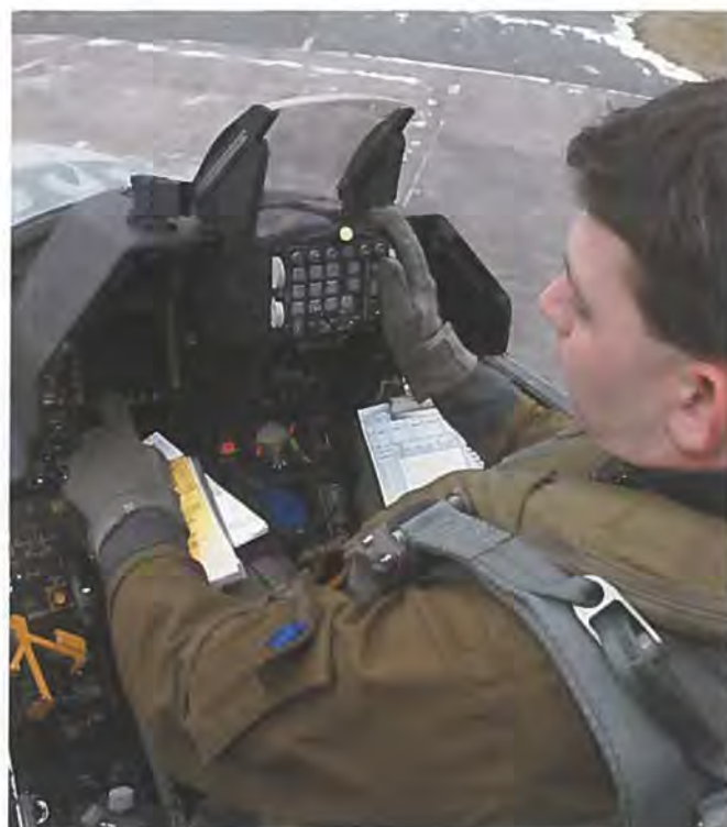
Med Link-16 modtager piloten langt flere oplysninger end tidligere, og i stedet for kun at høre dem via hovedtelefoner i hjelmen, får han dem overskueligt præsenteret på skærmen til venstre i cockpittet. Oplysningerne kommer fra de andre enheder i netværket, og piloten ser på den måde også det, de andre ser.
