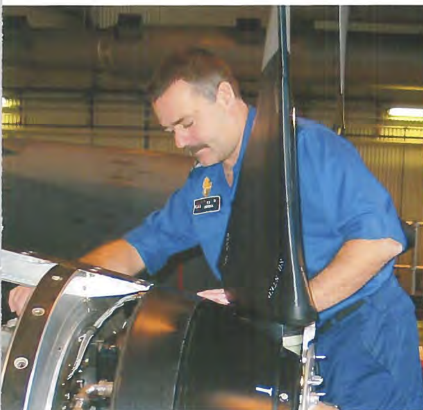
Bo Gerdes ser frem til de nye Hercules-fly. Eksempelvis tager det en dag at skifte propel på den gamle udgave, mens det kan ordnes på to timer på den nye.
