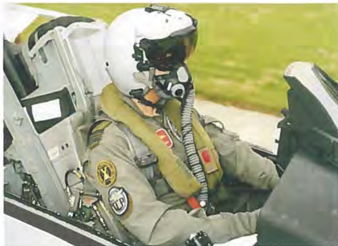
Hjelmonteret sigte har vist sig at være en endnu bedre kapacitet end først forventet. Piloten kan blandt andet se andre fly direkte på hjelmen. Det har betydning i forhold til, hvor hurtigt han kan reagere.
