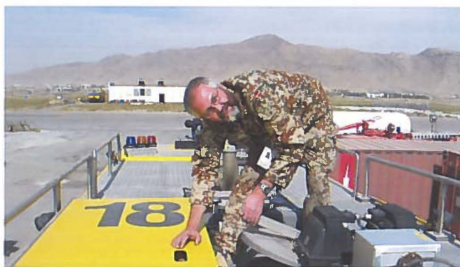
Bjarne kontrollerer vand- og skumbeholdning rutinemæssigt, når vagten er begyndt.
