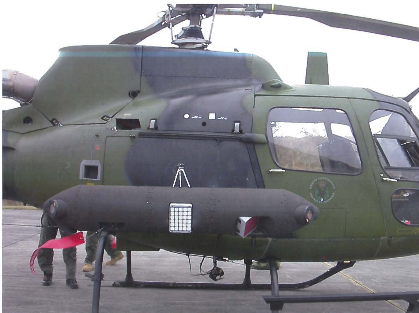
Flarebeskyttelsen består af en pod, som er monteret på hver side af helikopteren.
