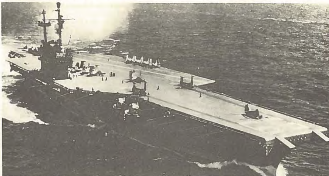
RR US FORESTAL-kl, depl: 76000 t, dimensioner: 317 x 76 x 11 m, fart: 34 kn, 85 fly. Bemærk artilleriet, der kun består af 4 stk 127 mm kanoner, som iøvrigt skal erstattes af missiler.(SAM).
