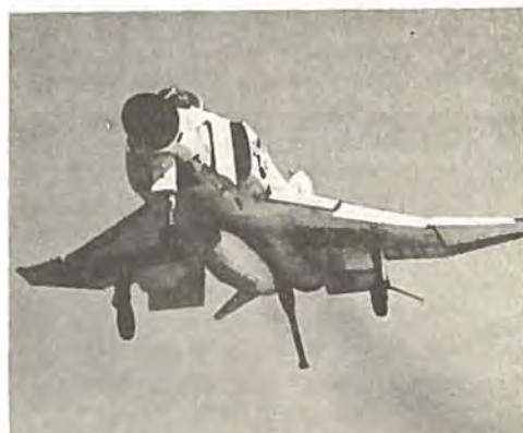
Den amerikanske hangarskibsbaseret jager F-4A PHANTOM II under landing. Bemærk gribekrogen, sænket til at tag fat i bremsewirerne.
