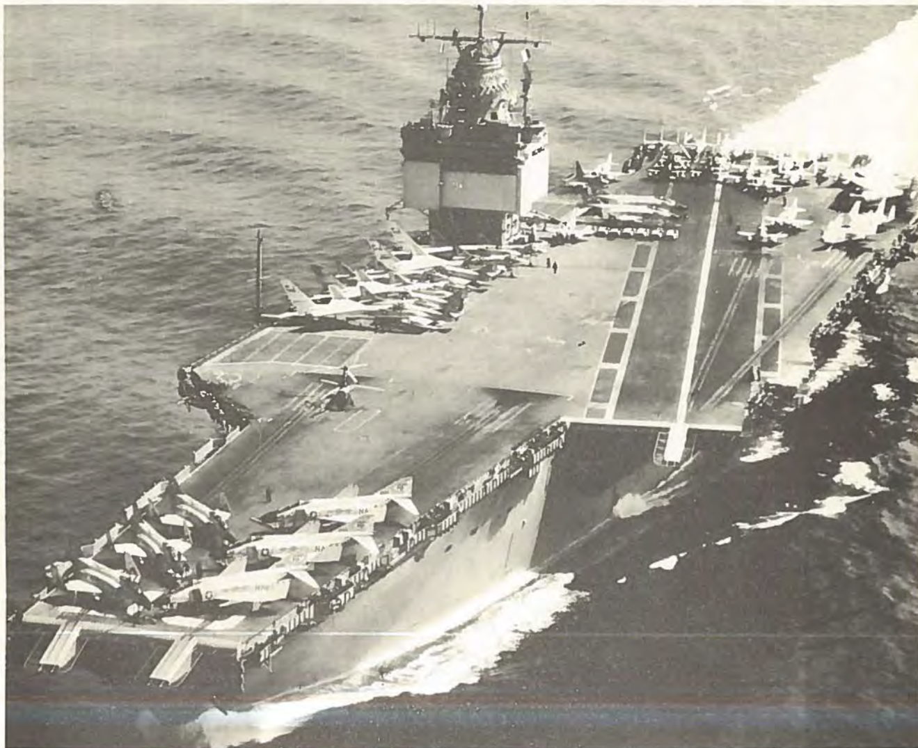
RR US ENTERPRISE, 85000 t, 336 x 76 x 11 m, 36 kn, aktionsradius 300000 sml. ved 33 knob (atommaskineri). 110 fly, pris 500 millioner dollars. Bemærk landingsbanen, der er skrå for at give plads til opmarchområdet foran broen og for de to dampkatapulter på fordækket. I stb's side er der foran og agten for broen elevator til klargøringsdækket.
