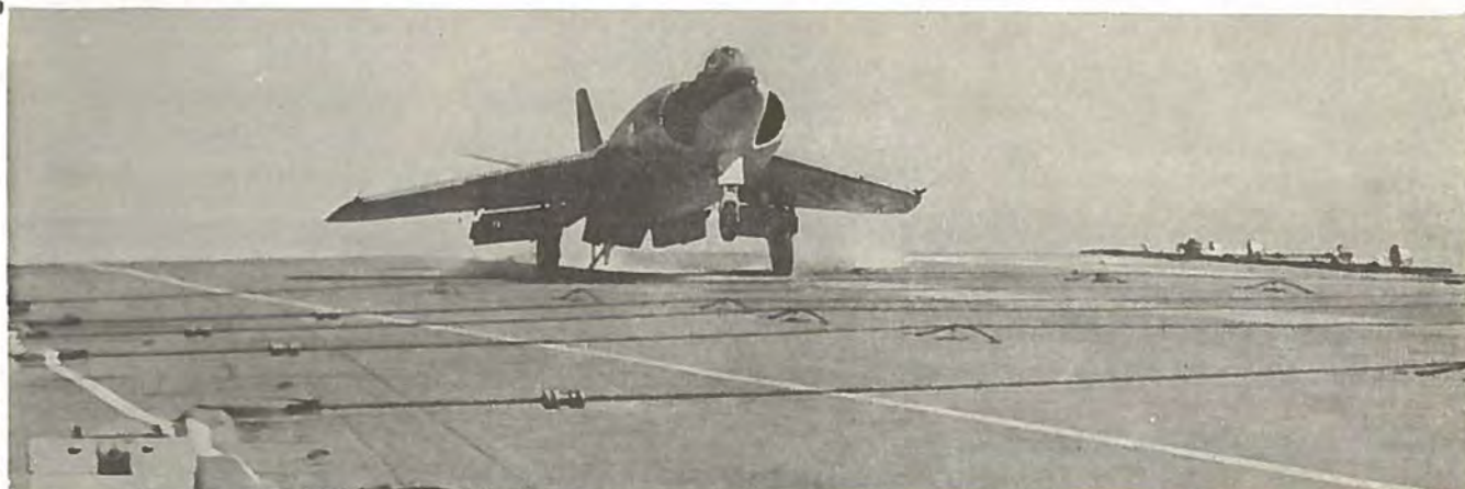
Den engelske jager SCIMITAR under landing henholdsvis start. Bemærk gribekrogen på billedet øverst til højre og wirestroppen fra katapulten øverst til venstre. Bemærk også bremsewirerne tværs over dækket.
