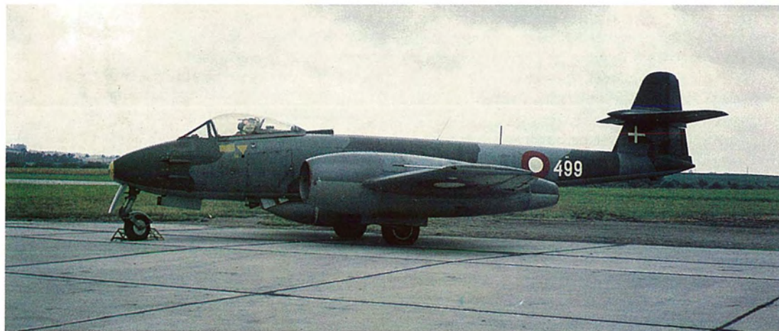
METEOR F.Mk.8 var efterfølgeren til F.Mk.IV i dagjagerrollen. Man kan tydeligt se forskel på de to typer, når man betragter halefinnen.
