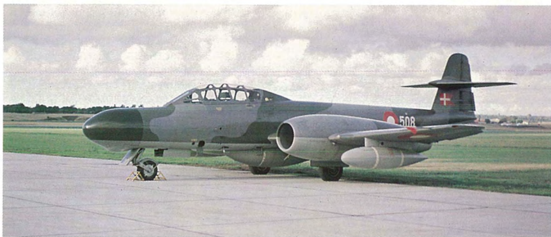
METEOR N.F.Mk.11 havde samme hale som F.Mk.8, samme canopy som T.Mk.VII, og en lang næse hvori radaren var monteret. 51-508 var blandt de seks fly, der blev ombygget til T.T.Mk.20.
