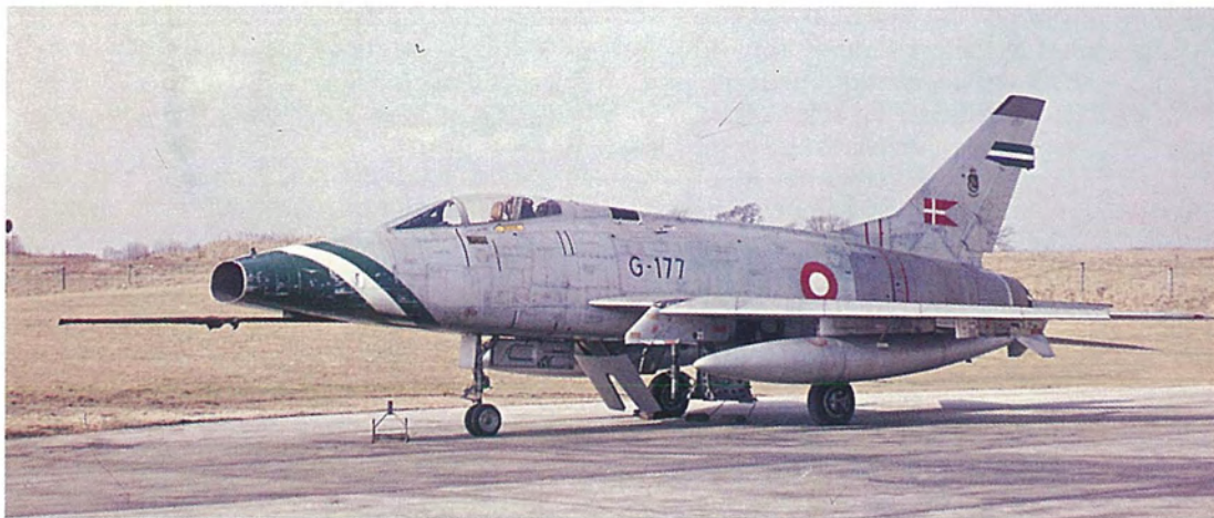
F-100D, G-177 fra ESK 730 i begyndelsen af 1960'erne. Sædets røde nakkestøtte afslører, at flyet endnu ikke er blevet udstyret med det engelske Martin-Baker sæde. Den grøn-hvide bemaling på næse og hale var ESK730's kendetegn
