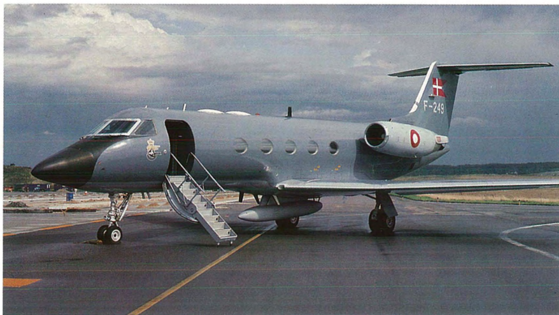
G-III, F-249 blev udvalgt til at fungere som testfly for en speciel radar udviklet af Elektromagnetisk Institut på Danmarks Tekniske Universitet. Radaren er monteret i droptanken under flyets bug.
