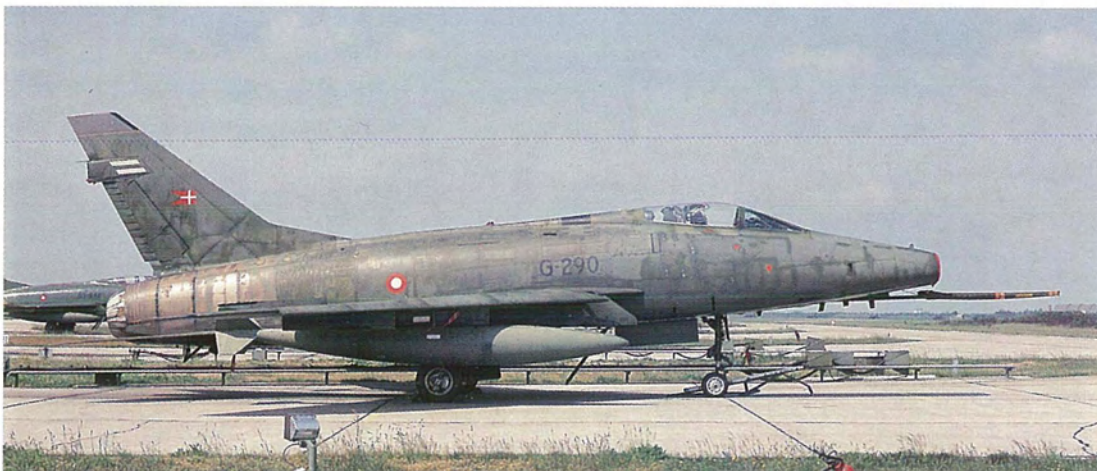
G-290 viser hvorledes, den matgrønne camouflage blev blakket og vejrbidt. Især på bagkroppen er det slemt på grund af varmen fra motorens efterbrænder.
