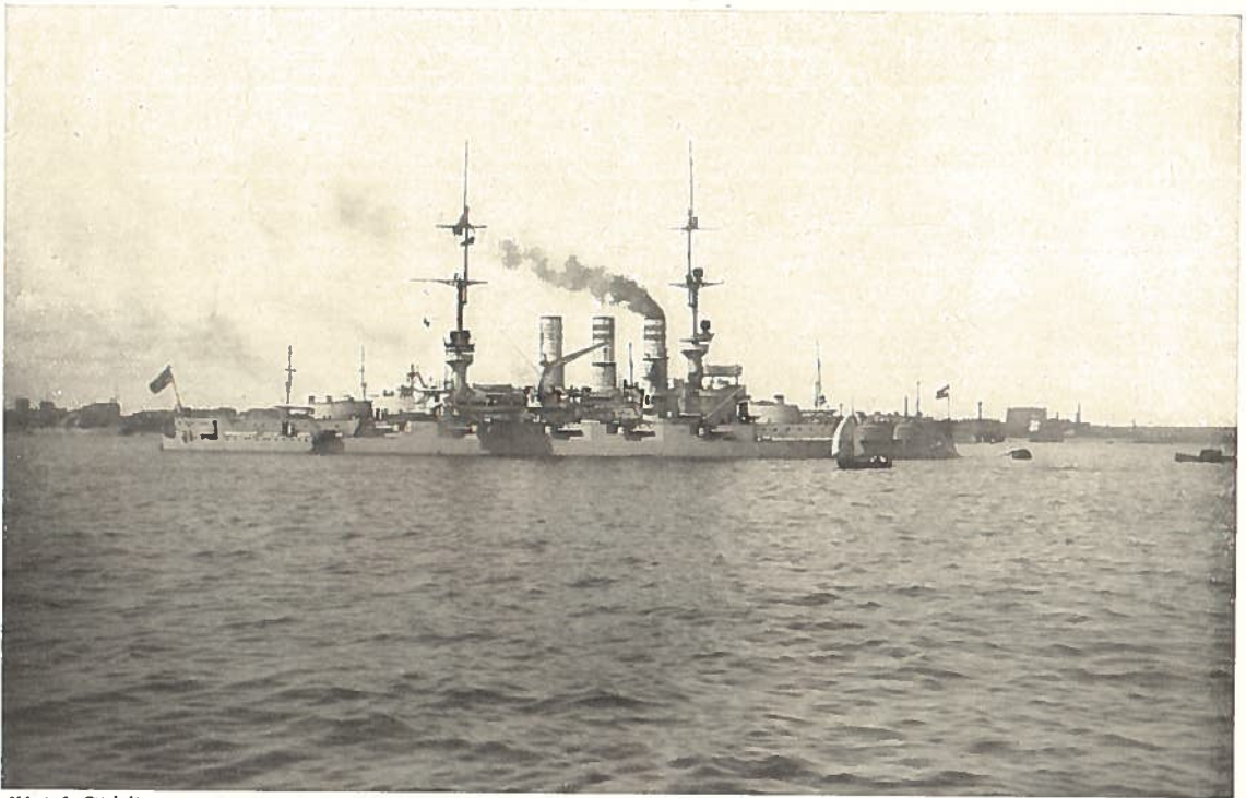
S. M. S. „Deutschland“, Linienschiff, 13 200 Tonnen; 19,3 Seemeilen Geschwindigkeit, war lange Jahre Flottenflaggschiff
