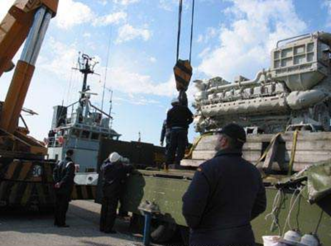
hoved motor bliver løftet ned
