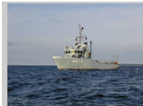
Minerydningsdrone MSF4 trækker Side Scan Sonar hen over havbunden.
