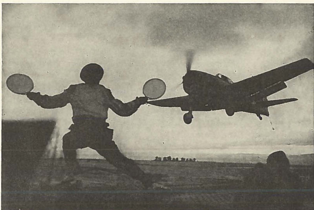
En „Hellcat“ lander paa det engelske Escorthangarskib „Ravager“. Enhver Landing foregaar paa Signal af Landings-officeren, der er forsynet med to „Ketchere“, hvormed han vinker Luftfartøjet ned. Sker der Havari ved en Landing, viser han de følgende Maskiner af, indtil Dækket atter er klar
