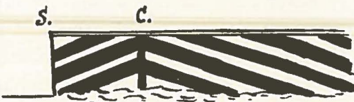
Et Skib, der er camoufleret paa Boven, som vist her, vil i visse Belysninger set fra en Ubaads Periskop illudere, som om Stævnen laa ved C i Stedet for S og derved give et falsk Indtryk af Kursen
