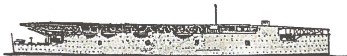
Engelsk Glatdæks-Aërodromskib „Argus“ (1918). Masten kan svinges vandret ned og Navigationstaarnet sænkes som en Slags Elevator, hvorved dets Tag kommer i Flugt med Flyvedækket, saaledes at Flyvedækket under Maskinernes Start og Landing er fuldstændig glat og uden nogensomhelst Forhindringer
