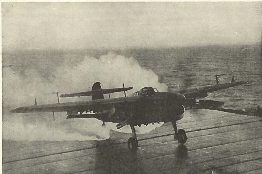
Da Startlængden er begrænset i de mindre Hangarskibe, anvendes nu ofte Raketter til Hjælp ved Starten. Her ses en Barracuda-Maskine foretage Raketstart fra Escorthangarskibet „Trumpeter“
