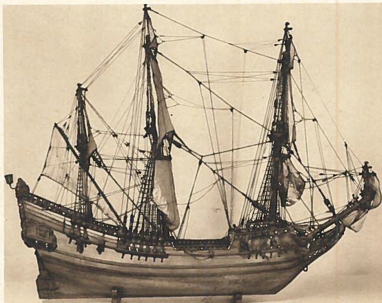
Från slutet av den här skildrade perioden daterar sig originalet till denna holländska pinassmodell (den svaga bestyckningen visar, att det ej är fråga om en örlogsman), men skrovet svarar ganska exakt mot den svenska örlogsbestyckade pinassritningen från 1660 (sid. 263). Skeppet bör, av akterspegelsdekorationen att döma, ha hetat Kamelen eller Dromedaren. — Kopia efter original i Nederlandsch Scheepvaart Museum, Amsterdam, i Sjöhistoriska museet, Stockholm.
