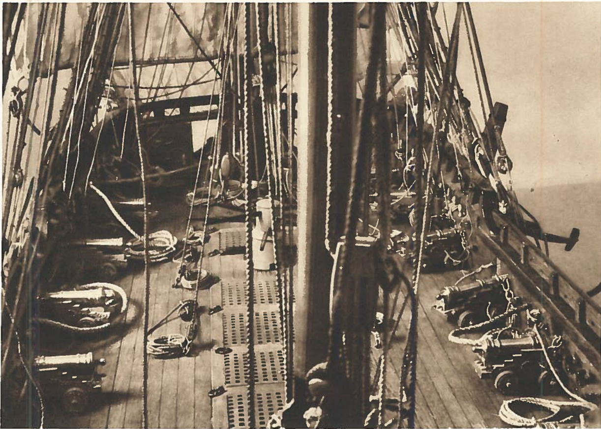
Denna och närmast följande bilder, som äro tagna ombord på den modell, som antages återge 50-kanonskeppet Amarant (jfr ovan sid. 242 ff.), äro avsedda att ge en möjligast konkret föreställning om sjöfolkets arbetsmiljö vid 1600-talets mitt. Bilden här ovan är tagen från halbdäcket och föröver. Närmast i förgrunden stormasten med dess taljor och grova taljeblock. Det övre lagets kanoner synas vid portarna i brädgången. De ligga i beslagna »fyrarullalådor», genomträdta med brokar för uppstoppning av rekylén. De segel, som synas på bilden, äro foc-ken och vaterblindan, som skymtar fram under denna. — Sjöhistoriska museet, Stockholm.
