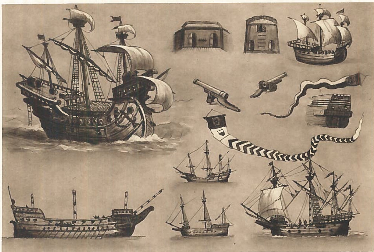
En samling teckningar av ett antal samtida skepp och skeppsdetaljer från 1500-talet. Särskilt det stora skeppet överst till vänster förefaller relativt trovärdigt återgivet — inte minst intressant är det kring stormasten spända nätet, avsett att skydda personalen för vissa kastvapen, från nedfallande delar av tacklingen etc. Från samma tid — omkring 1525 — härrör originalet till teckningen överst till höger ävensom de bägge lavettkonstruktionerna, medan de bägge kastellen, respektive akter- och förkastell, ovanför dem äro daterade omkring 1570. De bägge väldiga vimplarna, bulsanerna, äro kopierade från en samtida bild av Der grosse Adler, Hansans stolthet . En samtida akterspegel ses emellan dem. I mitten synes en kejsarlig fyrmastare från seklets mitt, medan Hansaskeppet nederst till höger, också en av havens dåtida jättar, och tremastaren till vänster därom äro daterade respektive 1560 och 1558; längst till vänster ett skrov från ett skepp ur den stora spanska armadan mot England 1587 — märk drorna från undre däck. — Sammanställning å Museum für Meereskunde, Berlin.
