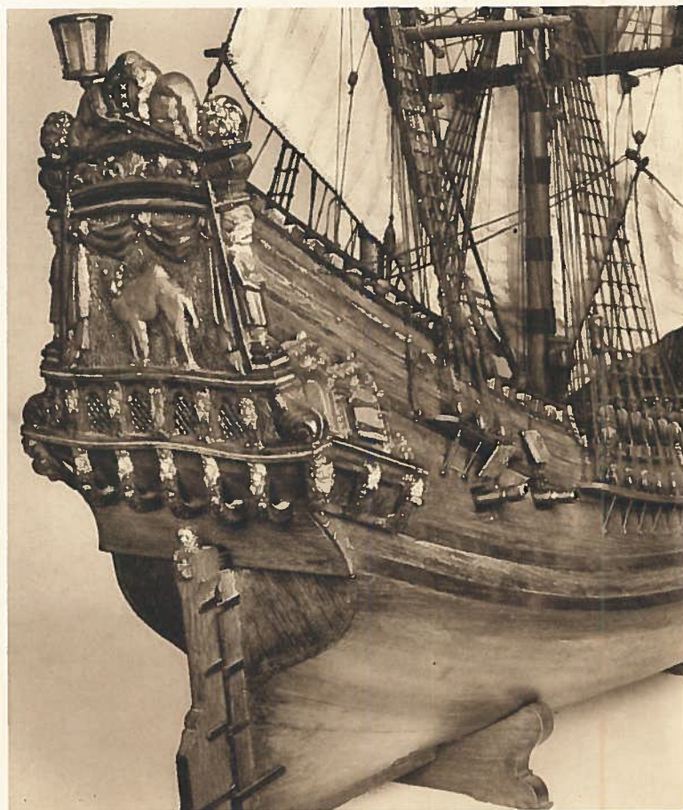
Från slutet av den här skildrade perioden daterar sig originalet till denna holländska pinassmodell (den svaga bestyckningen visar, att det ej är fråga om en örlogsman), men skrovet svarar ganska exakt mot den svenska örlogsbestyckade pinassritningen från 1660 (sid. 263). Skeppet bör, av akterspegelsdekorationen att döma, ha hetat Kamelen eller Dromedaren. — Kopia efter original i Nederlandsch Scheepvaart Museum, Amsterdam, i Sjöhistoriska museet, Stockholm.
