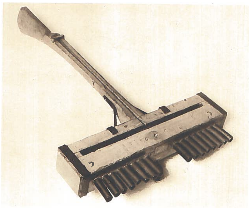
Om användningen av denna »skottbalk» eller »orgelbössa», ett intressant kuriosum ur 1600-talets marinarsenal, är tyvärr ingenting närmare känt. Man har emellertid förmodat att den begagnats vid antring och dylika tillfällen. Vapnet, som är c:a 75 cm. brett, har 16 svagt utstrålande pipor av järn; bakom dem löper en skåra, väl avsedd att fyllas med krut; en annan skåra, som mynnar ut i denna, löper längs kolven; avfyrningen skedde antagligen genom att antända krutet i denna. — Örlogsvarvets museum, Karlskrona.
