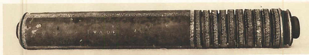
Till de fåtaliga enkla instrument, som voro outhärliga ombord under en sjöexpedition, hörde framför allt kikaren eller »perspektivet». De två här avbildade, som bestå av två linser, infattade i pergament- eller läderklädda metallrör, inskjutbara i varandra och möjliga att dra ut till mycket ansenlig längd, höra till den Wrangelska instrumentsamlingen på Skokloster från 1600-talets mitt.
