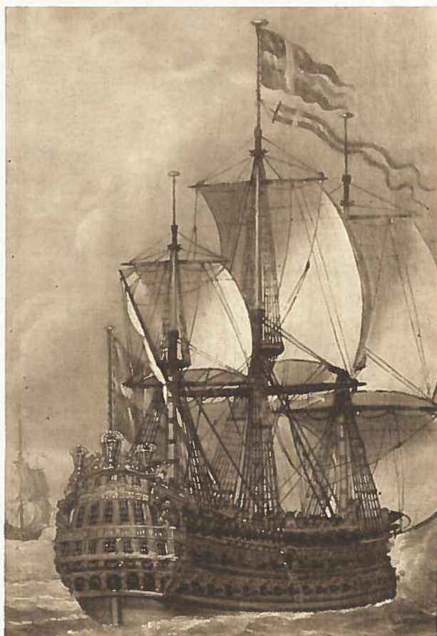
På detta vackra skeppsporträtt — Hans Wachtmeisters tredäckade flaggskepp Konung Karl under det stora nordiska kriget — är en tretungad örlogsflagga anbragt på kampanen (nationalitetsbeteckningen) och samma flagga jämte vimpel (utmärkande amiralens värdighet) på stormasttoppen. Bilden åskådliggör också, att den tidens flaggor inte hissades med hjälp av lina; de voro i stället låtsade vid en stång, vars nedre del stacks fast i ett urborrat hål i topparna, respektive kampanen. — Detalj av den ovan sid. 467 återgivna målningen av J. H. Wedekind.
