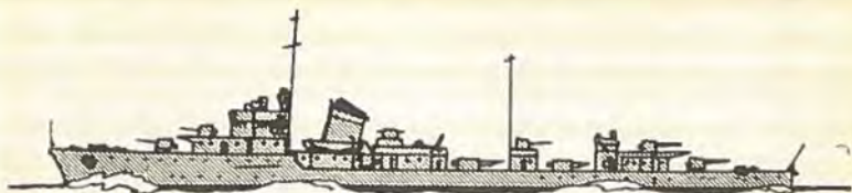
Russisk Jager »Gromki«. (1938). Opstilling: (2 \times 1) + (2 \times 1) . Kanonen lige ngten for Stormasten er Luftskyts. Skorstenen er i de fleste Enheder svære end vist paa Silhuetten: jfr. Billedet paa næste Side.
