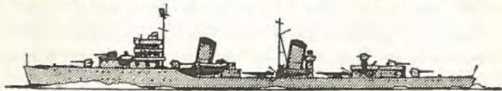
Russisk Torpedokrydser »Leningrad«. (1935). Kanonen mellem Bro og forreste Skorsten erstattet med Luftskyts.
