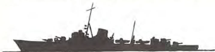
Silhuet af Torpedobaad af den tyske T III-Klasse (T 40-65). Man bemærker Højden og Længden af Forskibet i Sammenligning med T II-Klassen.
