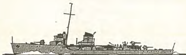
Norsk Torpedobaad (Kystjager) »Sleipner« (1936). (Torpedoupparat og øverste Kanon agter (X-Skjold) fjernet).
