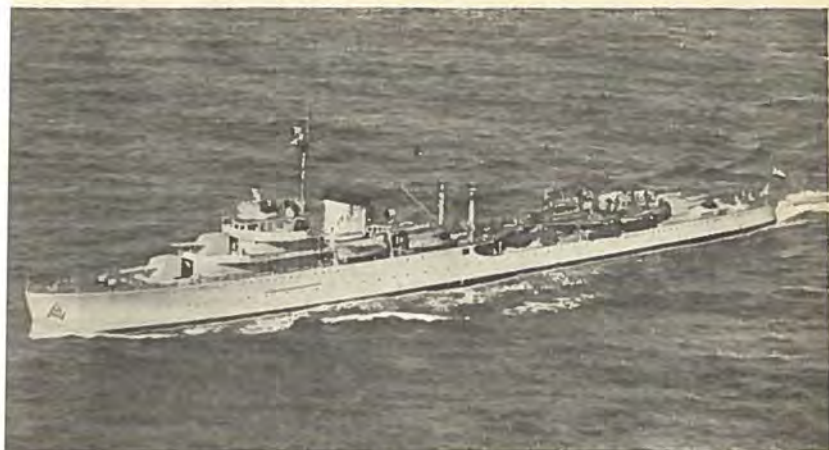
Hollandsk Torpedokrydser »Tromp« (1937). (De svære gulgeagtige Kraner agten for Skorstenen er senere fjernet).
